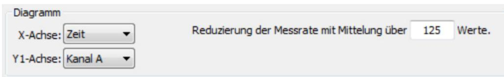
Im Eingabefeld ‚Reduzierung der Messrate mit Mittelung über X Werten.‘ ist es möglich, die Anzahl der zu speichernden Messpunkte zu verringern, indem Sie einen Wert für X eintragen. Die eingestellte Messrate z. B. 200/sek, wird folglich bei X=10 auf 20 Messwerte pro Sekunde reduziert und im Diagramm dargestellt. Beim Speichern der Messwerte in eine Datei ist es ebenso. Bei der Reduzierung der Messrate findet eine Mittelung über jeweils X Werte statt.
