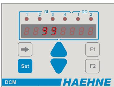
Durch das jeweilige Drücken der SET-Taste wurden veränderte Werte in den Zwischenspeicher abgelegt. Sollen diese Werte nun in den Lanzeitspeicher übernommen werden, muss im jeweiligen Block die Parameternummer 99 ausgewählt und zweimal mit der SET-Taste bestätigt werden. Danach wird das Menü schrittweise mit F1 verlassen.
