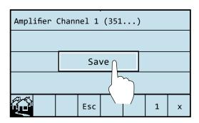
Durch Drücken auf "Save" werden die veränderten Parameterwerte des Verstärkerkanals (Level/Block/Kanal) in den Langzeitspeicher übernommen. Im Gegensatz dazu wird die Seite mit "Esc" ohne eine Speicherung wieder verlassen.
