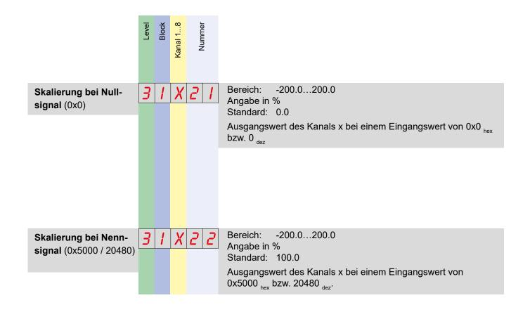
Die Eingangswerte der Signalquellen lassen sich getrennt skalieren. Sie müssen so skaliert werden, dass das Ergebnis noch innerhalb des zulässigen Bereichs liegen. Das Ergebnis wird auf ± 200% begrenzt. Berechnungsbeispiele zur Skalierung finden sich in Kapitel 6.3.3.
