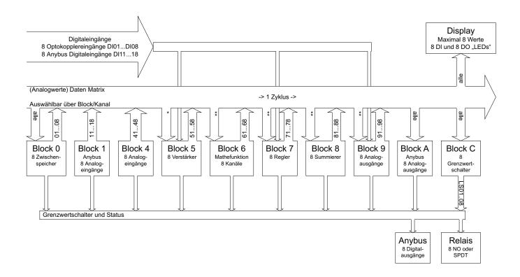
Auf dem Display sind bis zu 8 Analogwerte aus der Datenmatrix anzeigbar. Als Quelle stehen alle Blockausgänge zur Verfügung. Dies erleichtert die Fehlersuche in Kundenanlagen, z. B. können die Rohdaten der Sensorsignale ohne Messgerät überprüft werden.
