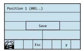
Durch Drücken auf "Save" werden die veränderten Parameterwerte in den Langzeitspeicher übernommen. Im Gegensatz dazu, wird die Seite mit "Esc" ohne eine Speicherung wieder verlassen.
