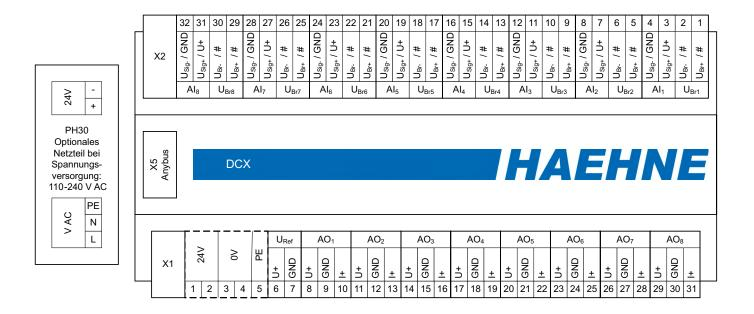
Bei der optionalen Spannungsversorgung von 110-240 V AC und den Gehäusen G1 bis G4 wird die 24 V Versorgung (X1 Klemme 1 u. 3) mit dem Netzteil PH30 vorverdrahtet.
