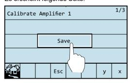
Durch Drücken auf "Save" werden die veränderten Parameterwerte in den Langzeitspeicher übernommen. Im Gegensatz dazu wird die Seite mit "Esc" ohne eine Speicherung wieder verlassen.
