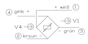
V4: Speisespannung V1: Signalspannung
